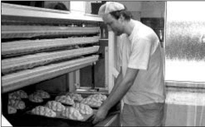
Vkládání vánoček do průběžné pece
