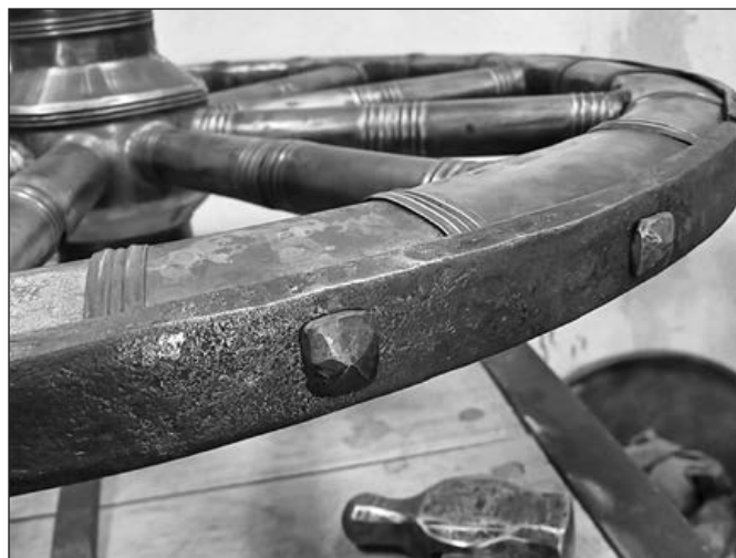
Okovaná část kola před dokončením, foto: Zdeněk Čermák
