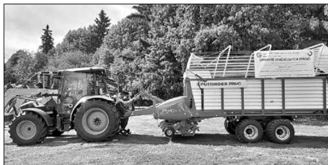
Traktor s čelním nakladačem a sběracím vozem
