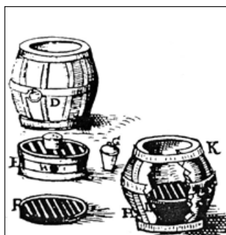
9C. Malá přenosná keramická pícka (s částmi zařízení) stažená železnými obručky (Ercker, 1586)
